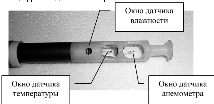
Рис.2. Головка сенсометрического щупа
